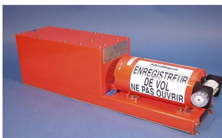
O FDR da aeronave registra muitas condições operacionais diferentes do vôo. Através de regulamentos, aeronaves recentemente fabricada tem que monitorar vinte oito parâmetros importantes, como tempo, velocidade aerodinâmica, e atitude de aeronave e etc.
